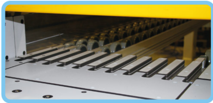
Modular HPL table top to ensure easy maintain as Standard . 標準工作桌面，採用模組化高壓多層板製造，容易維護。
