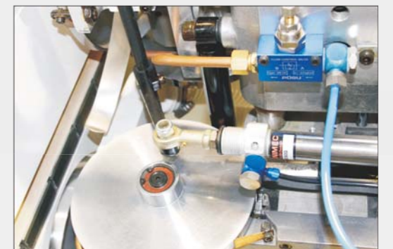
24. Auto backward for embossing surface 深壓紋自動退刀
