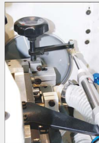
24. Auto backward for embossing surface 深壓紋自動退刀
