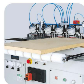
Front extension roller table for extra size top panel. 超寬槽可使用延伸滾輪架。
