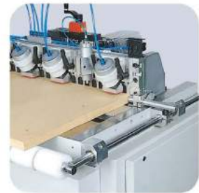
Symetry left & right stoppers, easy to use. 左右對稱球面靠點 可簡化操作。
